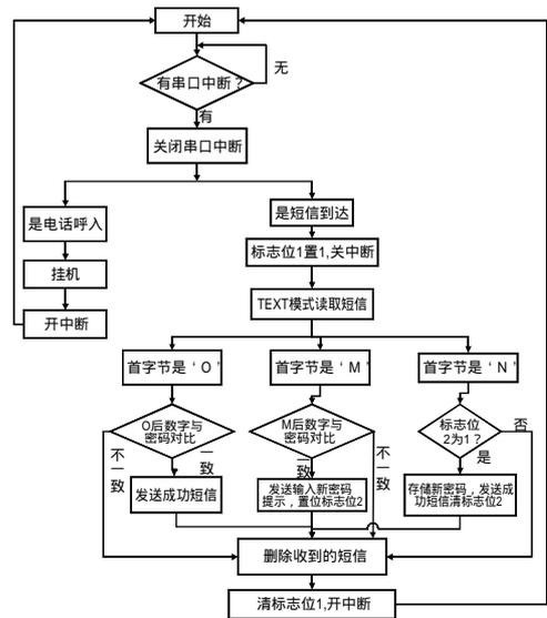
图6 远程开启与控制流程图
